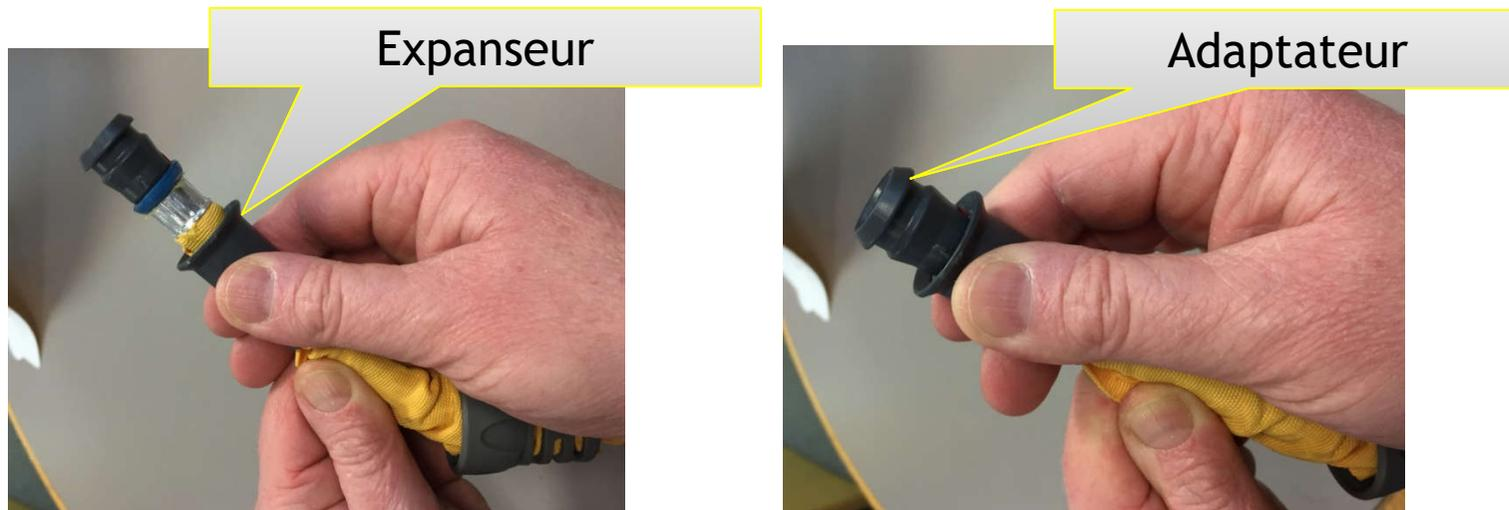
2. Clipper ainsi l'ensemble sur la partie mâle du raccord, en s'assurant que les "dents" de serrage sont toutes bien positionnées contre l'expandeur comme montré ci-dessous.
